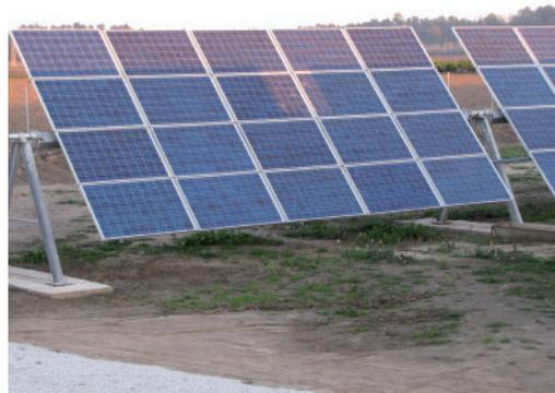
Fotografías 119 y 120. Módulos monocristalinos y multicristalinos. San Roque, Cádiz, y Alcolea del Río, Sevilla. Instalaciones FV 86/46
