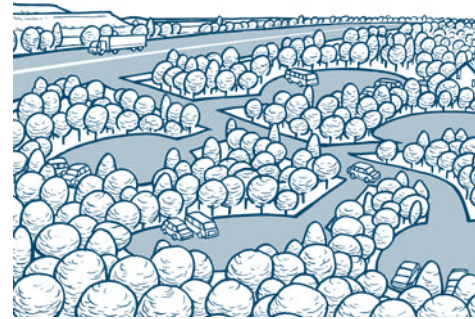
Una explanada única y continua tiene mayor presencia en el paisaje y es más dura que soluciones en las que las áreas de estacionamiento están fragmentadas y distribuidas.
